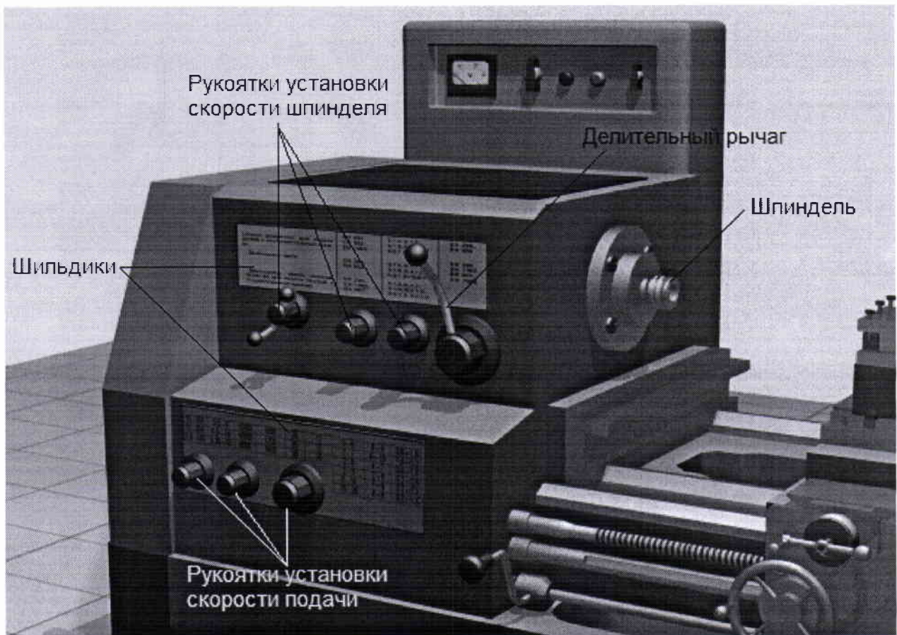
Рисунок 2. Устройство передней бабки токарного станка
