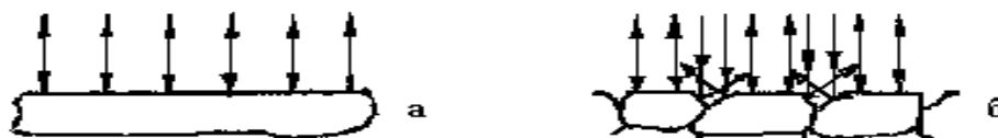
Рис. 3. Схема отражения световых лучей от поверхности полированного (а) и подвергнутого травлению (б) микрошлифа.
