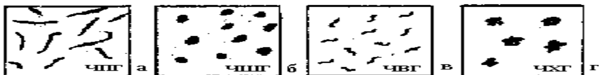
Рис. 6. Характерные геометрические формы включений графита в конструкционных чугунах (без травления шлифов): а - пластинчатая, б - шаровидная, в – вермикулярная, г - хлопьевидная (компактная).
