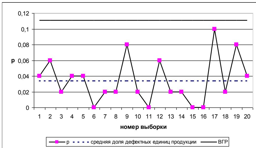
5 **Вывод:** на р-карте нет признаков разлаженности процесса. Поэтому процесс следует считать стабильным.
