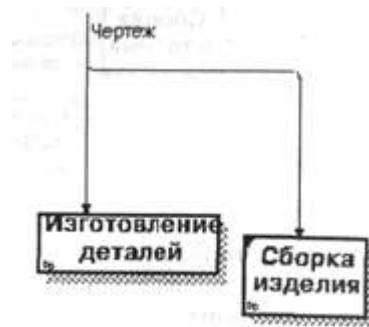
Рис. 1.2.17. Пример именованной разветвляющейся стрелки
