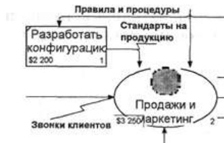
Рис. 1.4.28. Отображение работы в виде овала на диаграмме IDEF0
