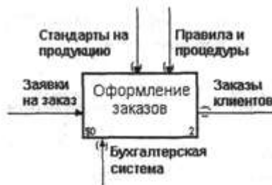
Рис. 4.15.3. Работа "Оформление заказов" на диаграмме A2
