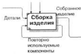
Рис. 1.2.32. Пример обратной циклической связи
