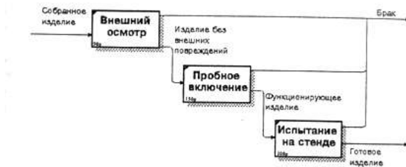
Рис. 1.3.6. Фрагмент диаграммы декомпозиции работы "Контроль качества "
