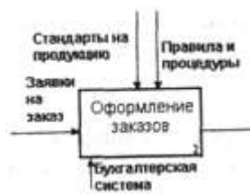
Рис. 1.4.31. Декомпозируемая работа на диаграмме IDEF0
