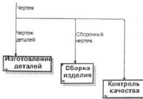
Рис. 1.2.18. Другой пример именованной разветвляющейся стрелки
