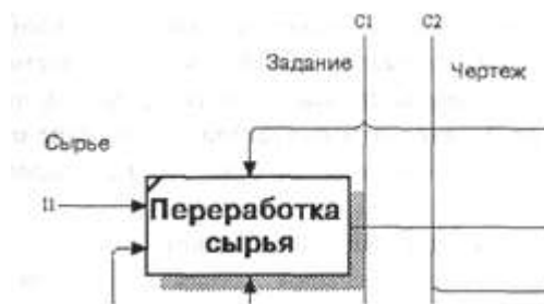
Рис. 1.2.9. Фрагмент диаграммы декомпозиции с ICOM-кодами (I1, C1 и C2)
