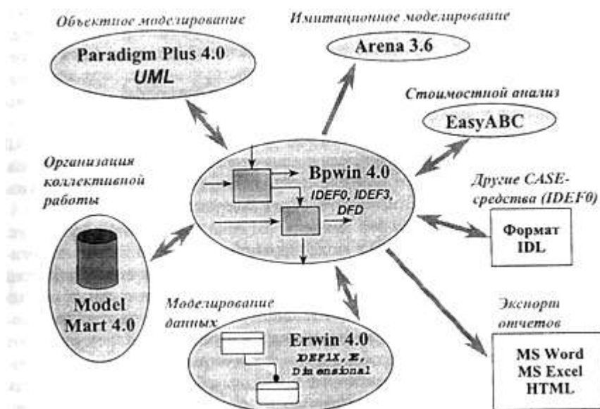
Рис. 3. Общая схема взаимодействия VPwin с программными продуктами Computer Associates и других фирм
