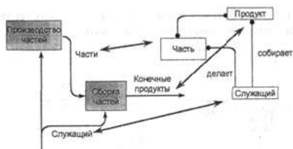
Рис. 3.1.3. Преобразование стрелки в сущность
